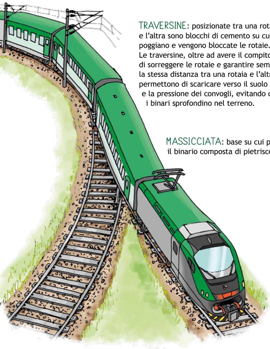
**TRAVERSINE:** posizionate tra una rotaia e l'altra sono blocchi di cemento su cui poggiano e vengono bloccate le rotaie. Le traversine, oltre ad avere il compito di sorreggere le rotaie e garantire sempre la stessa distanza tra una rotaia e l'altra, permettono di scaricare verso il suolo il peso e la pressione dei convogli, evitando così che i binari sprofondino nel terreno.
